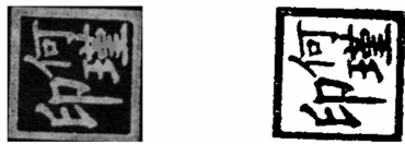
(e) Top-hat 变换 (f) Top-hat 变换后再用 Otsu 方法得到的二值图像 (e) Top-hat transformation (f) Thresholded top-hat image
