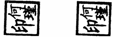
(e) 用和(b)中相同尺寸的结构元素处理(d)后得到的分割结果 (f) 结构元素半径增大为 20 个像素长度后得到的(d)的分割结果 (e) Thresholded top-hat result of the original image in (d) when the radius is 10 pixels (f) When the radius is 20 pixels
